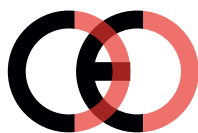
Faux marquage CE (trop proche)
