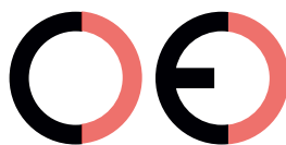
Faux marquage CE (trop éloigné)
